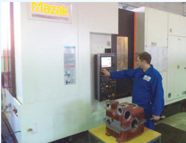
Горизонтальный обрабатывающий центр Nexus 5000-II фирмы MAZAK с двумя паллетами для обработки корпусных деталей редуктора в ООО «ЗДТ «Ареопэг»
