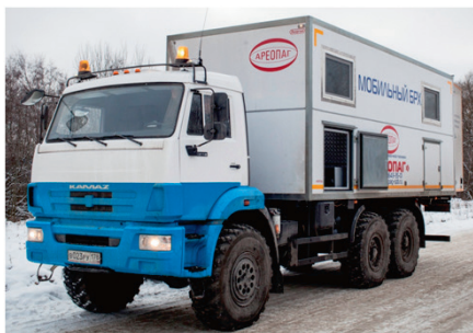
Мобильный блок непрерывного дозирования реагентов
